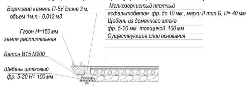
Схема 3 Конструкция покрытия тротуара. Примыкание к газону
